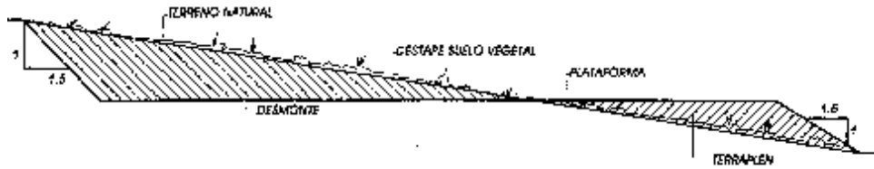
1º ETAPA: CONSTRUCCION PLATAFORMA
